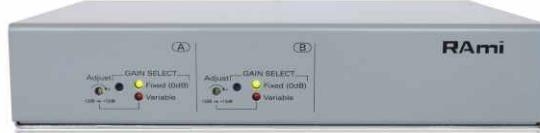
Cet amplificateur de grande qualité permet d'adapter en niveau et en impédance deux sources asymétriques ou symétriques vers deux départs mono symétriques sur transformateurs.
