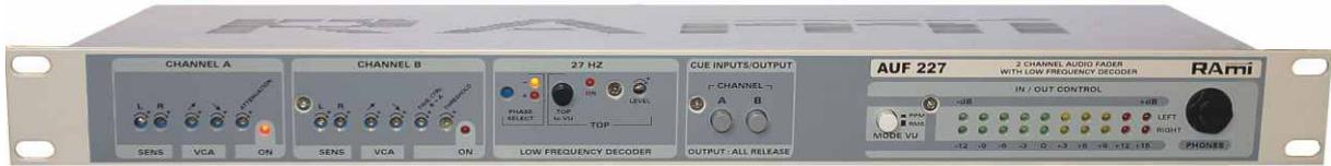
L'AUF227 est identique à l'AUF200S, avec un décodeur 27Hz intégré. Sur cet appareil, le passage d'un canal à l'autre peut s'effectuer, soit sur la présence de la modulation sur le canal B, soit sur l'envoi d'un 27Hz présent dans la modulation du canal B, soit sur une combinaison des deux. La commutation par une boucle extérieure est aussi possible.
