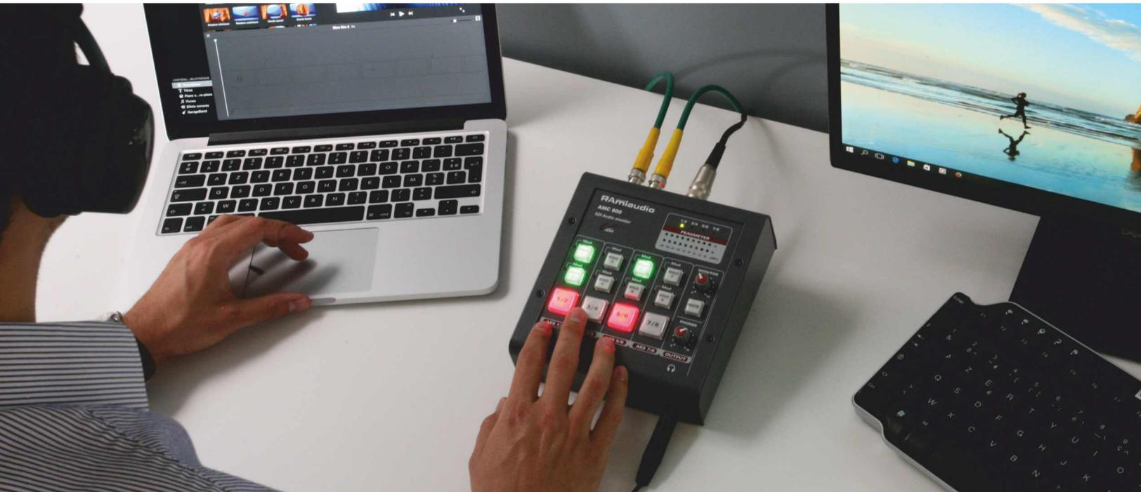
Cet équipement permet de contrôler le niveau, la qualité et la présence de l'audio dans les canaux AES d'une liaison SDI. La sélection s'effectue très rapidement grâce à un clavier ergonomique lumineux. Il est composé d'une touche pour chaque canal AES, et de deux autres solos pour permettre l'extraction individuelle de chaque canal audio. L'appui simultané sur les touches de canal AES permet le mixage des différents canaux AES.
