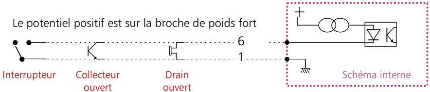
⇒ Le GPO fournit une tension de 24V pour allumer un voyant au niveau de l'interrupteur "coup de poing". Le voyant est allumé lorsque la télécommande de coupure a été activée et que l'audio n'est plus passant.
