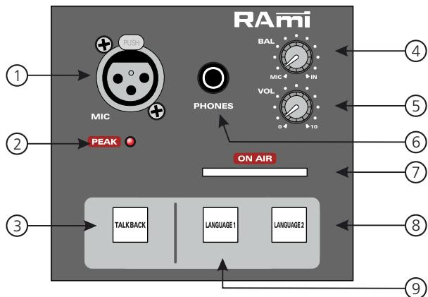
1: Embase XLR d'entrée microphone symétrique avec alimentation fantôme. (ajustage de la sensibilité par **A** en face arrière)
