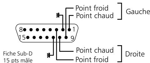
**B - Sortie "THRU" (analogique).** Elle reprend la modulation du connecteur (1) pour le branchement de plusieurs PCS 300.
