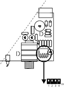
ATTENTION : l'AMC120 possède en interne, un réglage d'alimentation, limitant la puissance de sortie envoyée dans les casques. Ceci afin de s'adapter au type de casque utilisé (impédance du casque), pour éviter tout dépassement de la pression acoustique autorisée par la réglementation. Ce réglage s'effectue en configurant des dip-switchs.
